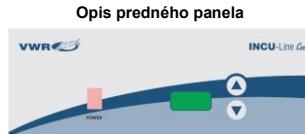
**POWER - sietový vypínač:** Zapína a vypína inkubátor. Svieti, keď je inkubátor zapnutý.
